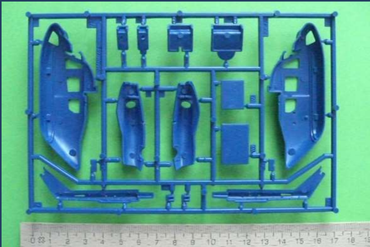
Erster Spritzling mit Kabinenhälften, Sitzen, Triebwerkverkleidungen und Heckausleger
