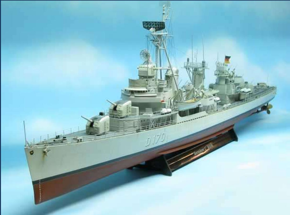
Es sind dies die Brücke mit dem halbrunden überdachten Vorbau und eine dadurch bedingte andere Form des darüber liegenden Decks, sowie eine andere Gestaltung der Hütte für die achtere Feuerleitanlage. Die Persenning an der Brücke ist aus Butterbrotpapier geformt, welches in Weißleim eingeweicht und außen an die Reling geklebt wurde.
